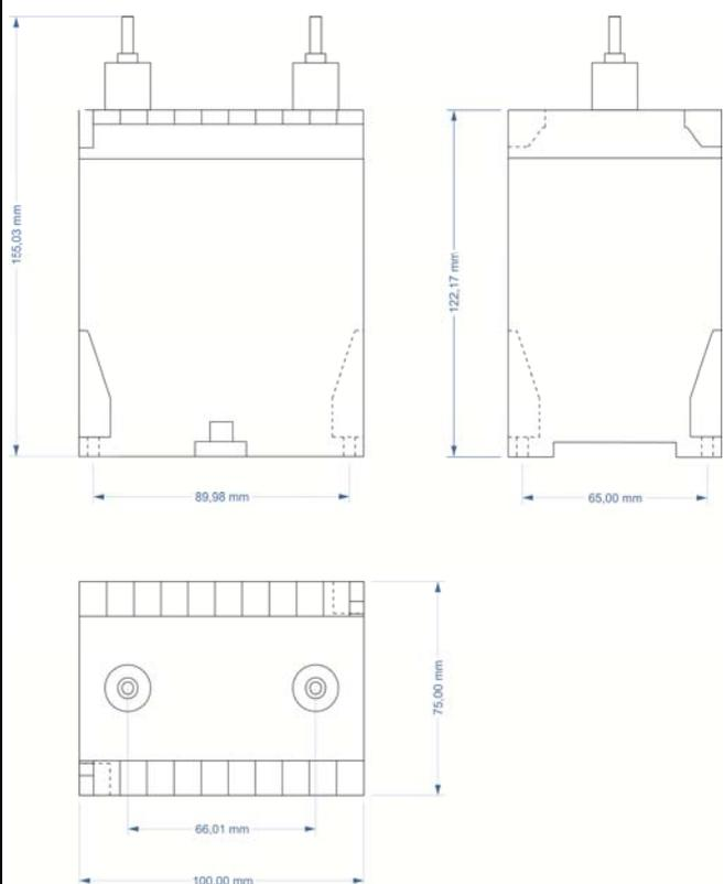
Terminais de saída: Caixa DIN de 10 terminais para fixação em trilho (35mm). Todas as dimensões em milímetros.
