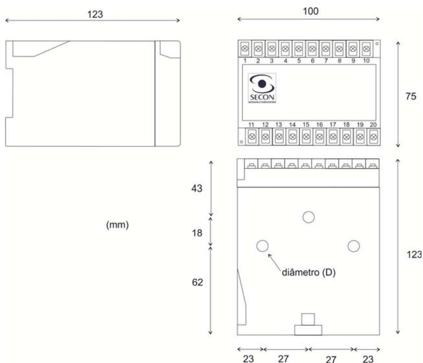
Terminais de saída: Caixa DIN de 20 terminais para fixação em trilho. Todas as dimensões em milímetros.
