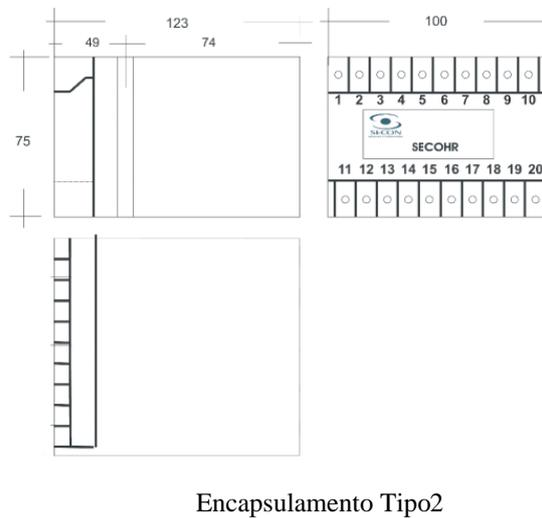
Terminais de saída: Caixa DIN de 10 terminais para fixação em trilho (35mm). Todas as dimensões em milímetros.
