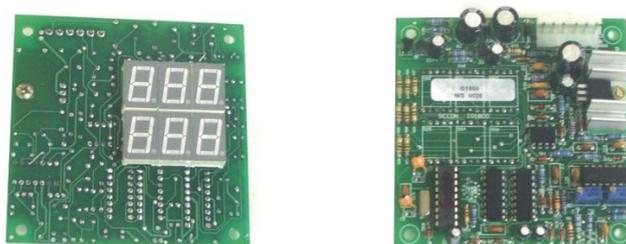
Possui displays de LED's de sete segmentos independentes para a corrente e para a tensão nas cores vermelho e verde respectivamente. O instrumento pode ser fornecido nas versões que mantêm os últimos valores lidos permanentemente (hold) ou apenas durante 2 segundos após a extinção do arco.
