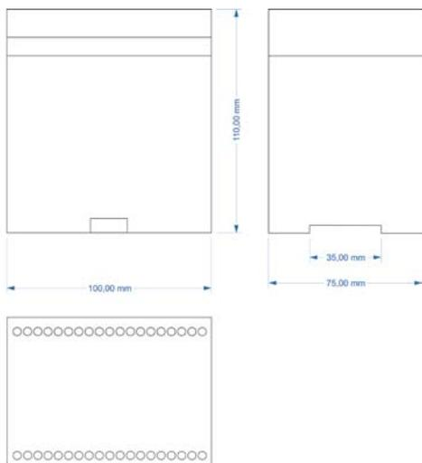
Encapsulamento padrão DIN de fixação em fundo de painel.
