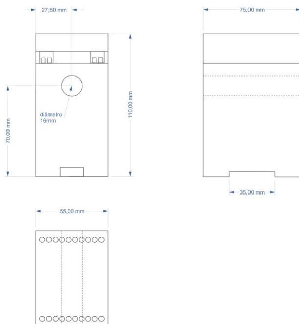
Encapsulamento padrão DIN de fixação em painel (trilho 35mm)
