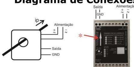
\* Indica o sentido convencional da corrente a ser medida. Um aumento da amplitude da corrente no sentido da flecha fará com que o sinal de saída seja crescente. Correntes no sentido contrário diminuirá a amplitude do sinal de saída.
