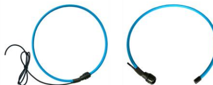
Sensor Rogowski ("TC Flexível") Padrão: 333mV Figura 3
