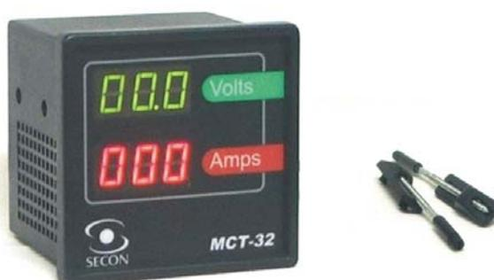
Possui displays de LED´s de sete segmentos independentes para a corrente e para a tensão nas cores vermelho e verde respectivamente. O instrumento pode ser fornecido nas versões que mantêm os últimos valores lidos permanentemente (hold) ou apenas durante 2 segundos após a extinção do arco.
