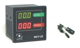
Possui displays de LED´s de sete segmentos independentes para a corrente e para a tensão nas cores vermelho e verde respectivamente. O instrumento pode ser fornecido nas versões que mantém os últimos valores lidos permanentemente (hold) ou apenas durante 2 segundos após a extinção do arco.
