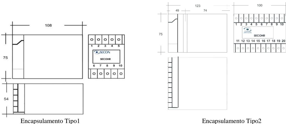
Terminais de saída: Caixa DIN de 10 terminais para fixação em trilho (35mm). Todas as dimensões em milímetros.
