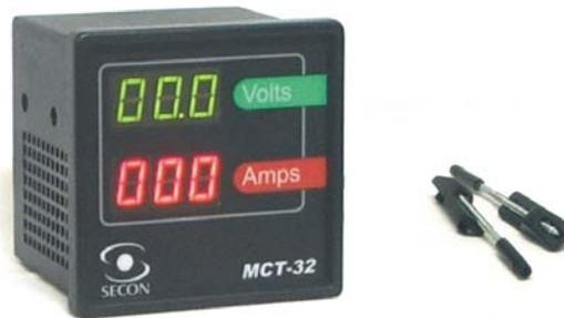
Possui displays de LED's de sete segmentos independentes para a corrente e para a tensão nas cores vermelho e verde respectivamente. O instrumento mantém os últimos valores lidos durante 2 segundos após a extinção do arco.
