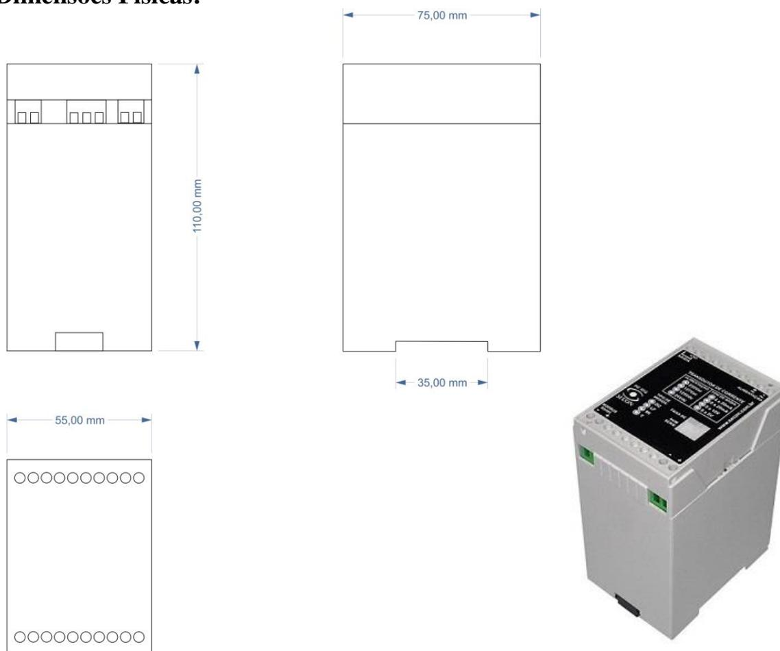
Terminais de saída: Caixa DIN de 10 terminais para fixação em trilho (35mm). Todas as dimensões em milímetros.
